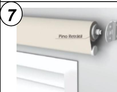
Aperte o pino para encaixar no suporte do outro lado, verificar se o pino entrou no encaixe do suporte
