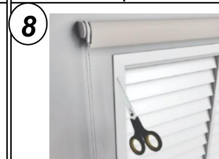
Travar a altura da corrente com o limitador
